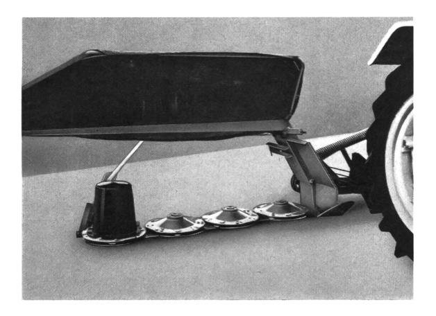
Barre de coupe très compacte. Hauteur de coupe réglable de 25 à 100 mm. Les disques à transmission inférieure consomment moins de puissance (24 CV prise de force). L'herbe coupée s'écoule librement par dessus les disques rendant inutile toute puissance supplémentaire pour l'évacuer.
