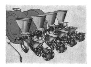
Le semoir monograine «Muli 330» que l'on voit ici (semoir de précision) comporte quatre éléments. Il permet d'exécuter les travaux suivants: préparation du lit de germination, localisation d'engrais en surface (fertilisant conduit au sol par un ou deux tubes disposés de chaque côté de la ligne de semences), dépôt des graines une à une dans le rayon, pulvérisation au moment du semis (en tant que traitement localisé ou généralisé).
