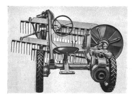
Aspect d'un râteaufaucheur automoteur à tambour. Les barresporte-dents forment un angle variable avec les flasques latéraux.
