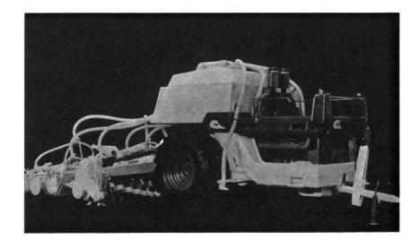
Machine combinée de proportions gigantesques destinée à exécuter plusieures opérations en même temps. Elle comporte une fraise à lames, un pulvérisateur, un distributeur d'engrais et un semoir.
