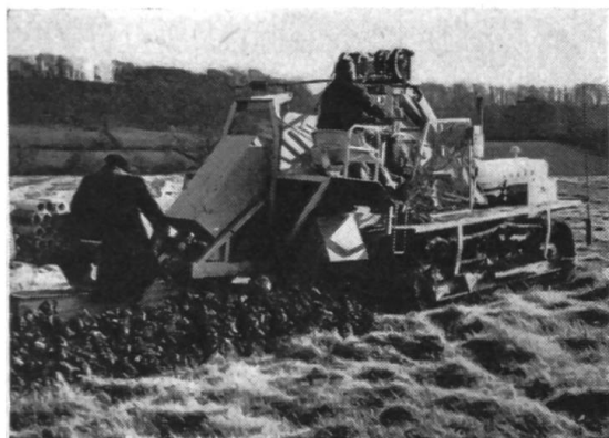
Aspect de la machine combinée «Landrainer» MK 4 à creuser les tranchées et poser les tuyaux de drainage (trancheuse-poseuse).
