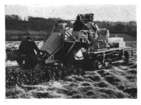
Aspect de la machine combinée «Landrainer» MK 4 à creuser les tranchées et poser les tuyaux de drainage (trancheuse-poseuse).
