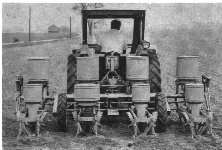
Fig. 1: Aspect d'une semeuse monograine à 4 éléments (semoirs de précision) équipés de localisateurs d'engrais. L'entraînement des organes distributeurs de ces éléments est assuré par les roues porteuses à pneus nervurés de la semeuse grâce à un arbre transversal et des chaînes motrices (commande collective). Au centre, on distingue le carter ouvert du boîtier de transmission à engrenages.
