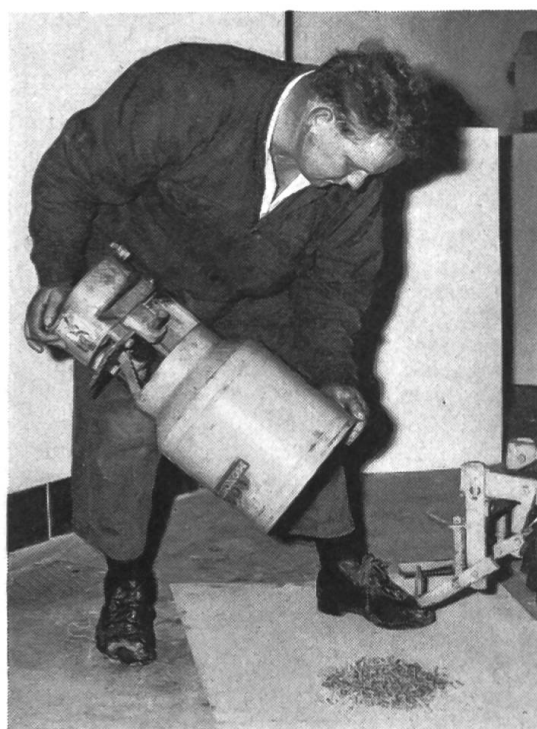
Fig. 3: La trémie d'alimentation montée sur chaque élément semeur (réservoir à graines) est fixée au cadre porteur par des boulons lorsque son vidage se fait par l'ouverture d'une vanne de vidange. Quand elle est fixée à ce cadre par des pinces, on peut l'enlever facilement et son vidage a lieu alors plus rapidement. Ce dernier système est celui qu'on a adopté pour la semeuse représentée ci-contre. Il s'avère surtout utile dans les cas où il faut employer successivement des semences de plusieurs sortes (entrepreneurs de travaux à façon, communautés d'utilisation de matériels agricoles).
