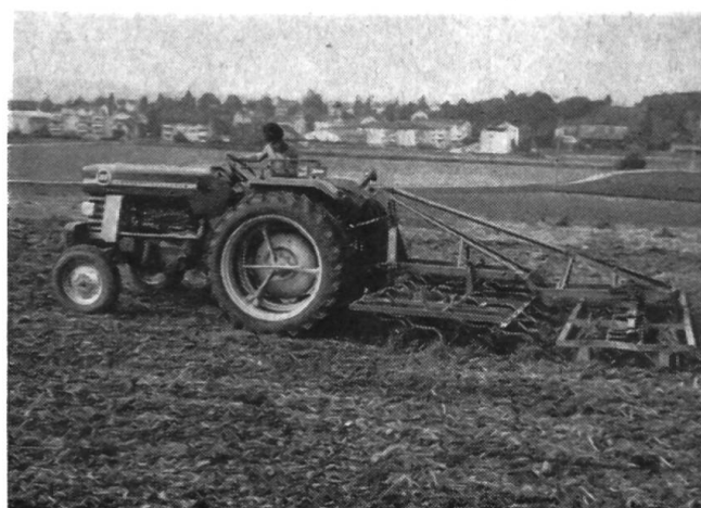
Fig. 3b: La structure exigée pour un lit de germination peut être généralement obtenue après une façon supplémentaire effectuée à l'aide d'un vibroculteur.
