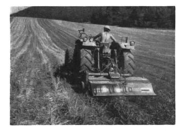
Fig. 2: Une herse rotative commandée à bêches comme la Rotovator émiette finement le sol et enfouit les déchets végétaux en les mélangeant bien à la terre.
