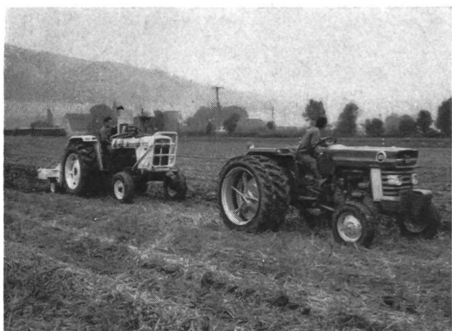
Fig. 4: Détermination de la puissance exigée à la prise de force grâce à un moyeu électronique de mesure et de l'effort de traction nécessaire à l'aide d'un tracteur remorqueur à essais.
