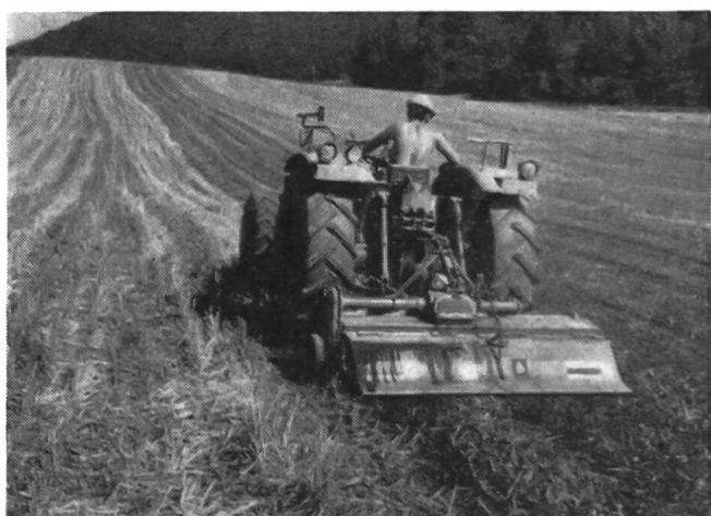
Fig. 2: Une herse rotative commandée à bèches comme la Rotovator émiette finement le sol et enfouit les déchets végétaux en les mélangeant bien à la terre.
