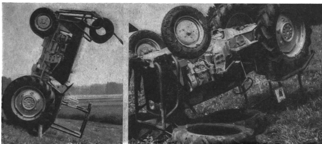
Fig. 8 et 9: Essai C: Le tracteur est placé sur une pente en position de montée et l'on provoque son renversement d'avant en arrière. Des montants ou des parties du cadre de sécurité ne doivent pas pénétrer sensiblement dans la zone de dégagement du conducteur.
