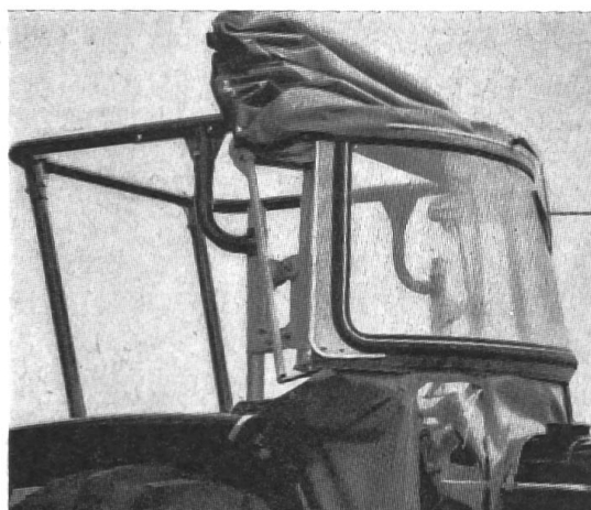
Fig. 2: Cadre de sécurité sur lequel une capote en matériau souple va être fixée.
