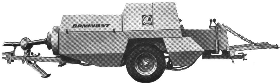
Les presses à haute densité ont fait leurs preuves chez plus de 50 000 agriculteurs et entreprises de battage. En un seul passage, la récolte est ramassée proprement, pressée, liée et, au besoin déchargée directement sur une remorque attelée. De construction robuste, les presses CLAAS peuvent affronter les plus dures conditions. Elles se distinguent par des bottes bien séparées, aux arêtes vives, avec ficelle encastrée. En plus, on est frappé par leur forme élégante, moderne et leur ligne basse.
