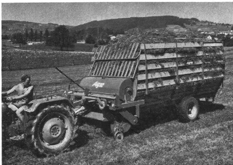
conducteur apprécie également l'accessibilité des organes de commande, qui se trouvent à portée de la main. D'autre part, le fait que le produit est ramassé juste devant les roues avant permet non seulement de diriger le véhicule avec précision mais encore d'éviter des pertes de fourrage
