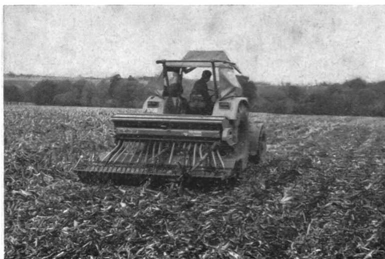
Fig. 6: Grâce au matériel combiné formé d'une fraise à lames coudées, d'un semoir en lignes et d'un rouleau plombeur, il suffit d'un seul passage pour arriver à bien incorporer les tiges de maïs sèches à la couche supérieure du sol et pour mettre correctement les graines en terre.
