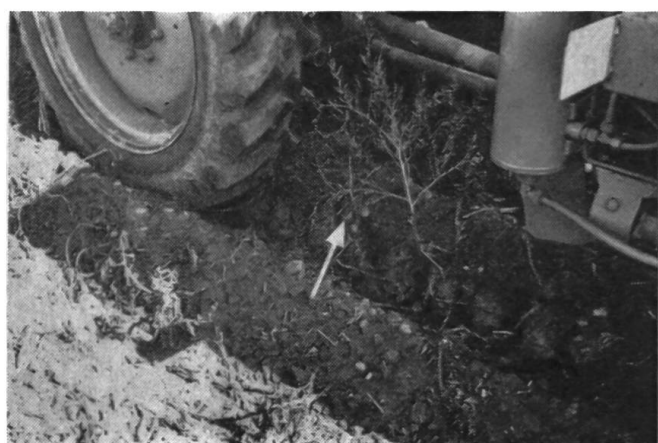
Fig. 2: Un pneu de tracteur à large boudin dans un interligne étroit est une chose que l'on voit souvent dans la pratique. Ainsi qu'on peut s'en rendre compte, la terre des flancs de la butte se trouve comprimée et les pommes de terre (flèche) sont endommagées par les sculptures des pneus!
