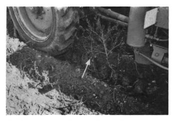
Fig. 2: Un pneu de tracteur à large boudin dans un interligne étroit est une chose que l'on voit souvent dans la pratique. Ainsi qu'on peut s'en rendre compte, la terre des flancs de la butte se trouve comprimée et les pommes de terre (flèche) sont endommagées par les sculptures des pneus!
