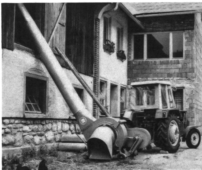
Fig. 5: Elévateur semi-pneumatique à fourrages (caractéristiques: pas d'injecteur, le produit passe par le ventilateur, projection mécanique et pneumatique) — La machine représentée ici est pourvue d'une espèce de trompe d'aspiration permettant la reprise des produits à partir du sol. Son entraînement est assuré par l'intermédiaire de la prise de force du tracteur, d'un arbre à cardans et d'un renvoi.
