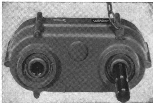
Chaînes SIMPLEX, DUPLEX et TRIPLEX pour couples jusqu'à 66 mfp entraxes de 213 et 332 mm.
