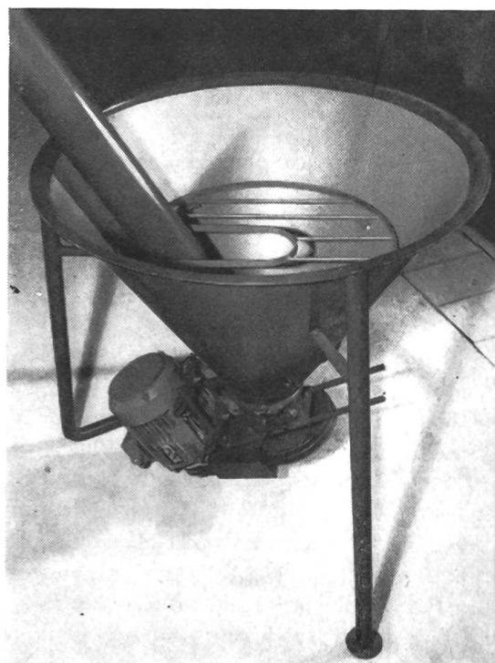
régler le débit à volonté, une bouche de sortie perpendiculaire à l'axe de la vis ainsi qu'un moteur électrique assurant l'entraînement de cette dernière par l'intermédiaire d'une courroie trapézoïdale et qui est montée à l'extrémité supérieure du tube. Normalement, un matériel de ce genre n'est donc pas équipé d'une trémie d'introduction. Par ailleurs, il est déplaçable et utilisable en toutes positions (possibilités d'inclinaison et de rotation).
