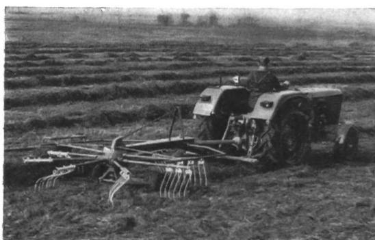
Aspect de la nouvelle andaineuse «Fahr» à toupie de grandes dimensions qui est fabriquée en deux exécutions différentes, soit le modèle KS 6 et le modèle KS 8, et peut être obtenue à volonté en tant que type porté ou tracté. L'andaineuse représentée ici est le modèle KS 8, dont la longueur de travail est de 2 m 80.
