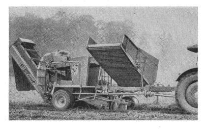
vent ainsi supprimés. Depuis peu, cette trémie peut être en outre convertie en plate-forme d'ensachage. Pour cela, il suffit de rabattre ses parois et de les mettre à l'horizontale, puis de monter une bouche d'ensachage à l'extrémité de la table de visite. L'élévateur incorporé à une paroi peut être éventuellement aussi utilisé pour le transbordement des sacs de pommes de terre.
