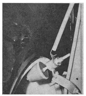
La roulette doit être fixée de telle manière qu'elle s'appuie bien contre la jante. N'importe quel tracteur ou moissonneuse-batteuse peut être équipée d'un compteur d'hectares DREES.
