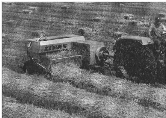
Fig. 2: La ramasseuse-presse «Claas» Constant est capable de mettre en balles 15 tonnes de fourrage à l'heure.
