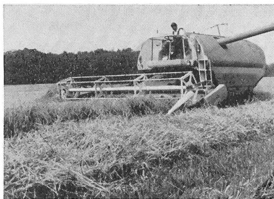
Fig. 3: L'entreprise «Claas» suit de nouvelles voies dans la fabrication des moissonneuses-batteuses. L'imposante et puissante machine que l'on voit ici est un prototype dont la barre de coupe possède une largeur de travail de 5 m 10. Elle devrait intéresser avant tout les entrepreneurs de travaux de moissonnage-battage.
