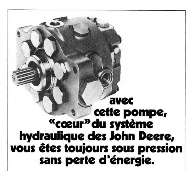
Un système hydraulique sur un tracteur, cela n'a rien d'exceptionnel. Seulement, sur les JOHN DEERE, il fonctionne en circuit fermé (closed center): une pompe à pistons radiaux, à pression constante et débit variable, véritable cœur, fournit au système toute la puissance nécessaire à la moindre sollicitation.
