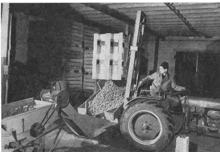
Fig. 5 et 6: Aspect d'une caisse-palette normalisée (paloque). Elle a 1 m 20 de long, 80 cm de large, 1 m 15 de haut et une contenance de 0,85 m 3 . La manutention des pommes de terre en paloxes dans l'agriculture a lieu à l'aide d'un élévateur hydraulique porté à fourche. Le vidage des paloxes s'effectue par basculage.
