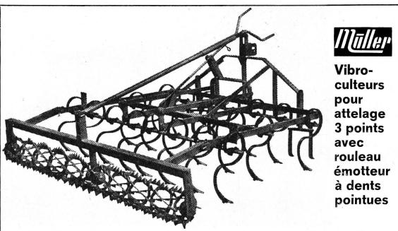
Cette combinaison ingénieuse permet de préparer en un seul passage un champ à emblaver de meilleure structure grumeleuse. Angle d'attaque réglable depuis le siège du tracteur. Haut rendement de surface, construction solide, prix avantageux. Trois largeurs de travail. L'émotteur peut être fourni seul; il s'adapte aux vibroculteurs de toutes les marques existantes. De plus amples renseignements par le fabricant
