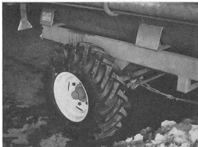
Fig. 2: Le pneu à profil AS (prévu pour roues motrices de tracteurs agricoles roulant en terre meuble et pourvu de barrettes de traction) se montre indiqué pour une remorque à un essieu quand elle doit souvent rouler sur des terrains en pente et posséder une bonne capacité de freinage.
