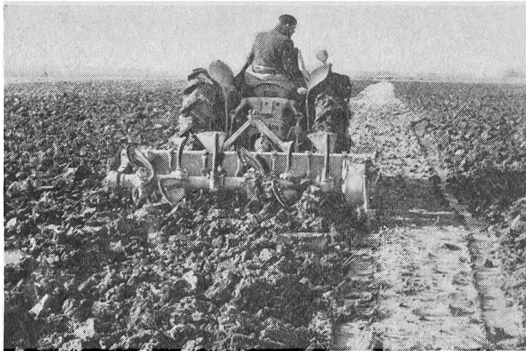
Fig. 5: Ce modèle de laboureuse rotative à bèches à une largeur de travail de 2 m 10. En raison de la vitesse de travail réduite qu'il faut adopter avec une machine de ce genre, on ne doit pas s'attendre à ce qu'elle s'impose dans un proche avenir pour la préparation des sols agricoles proprement dits.
