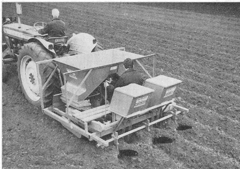
uns des autres sur cette bande, laquelle effectue leur dépôt dans le rayon. La planteuse en question est complétée par un localisateur d'engrais en profondeur. Cet appareil comporte deux tubes de distribution placés de telle façon que le fertilisant tombe de chaque côté des tubercules. Un tel système de fumure donne toute satisfaction, dit-on.
