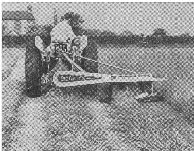
Fig. 9: Aspect de la faucheuse portée «Bamfords» à deux disques rotatifs à couteaux. L'entraînement des disques a lieu par le haut. Ce matériel de fauchage a une largeur de travail de 2 m et a été plus spécialement conçu pour les tracteurs de type léger.
