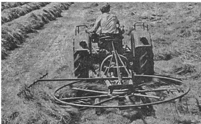
Fig. 11: L'andaineuse rotative portée «Kuhn» est constituée par un bâti circulaire fixe et un élément rotatif à bras porte-dents du type utilisé sur les faneuses à toupies. Le fait que ces bras sont commandés et dirigés confère à la machine en question de bonnes aptitudes pour le râtelage.
