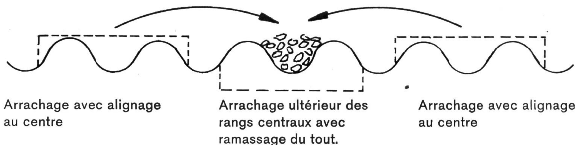
Fig. 11: Système de récolte des pommes de terre en deux phases avec une machine à deux rangs — Dans la première phase, seuls les tubercules des rangées extérieures sont déterrés (les 2 rangées de gauche et les 2 rangées de droite) puis déposés entre les deux rangées centrales (qui ne sont pas arrachées pour le moment) afin de pouvoir se ressuyer. Dans la seconde phase, les pommes de terre des deux buttes centrales sont déterrées et ramassées en même temps que celles des rangées extérieures qui gisent dans le sillon séparant ces buttes.
