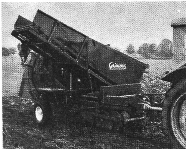
Fig. 9 et 10: Certaines machines à récolter les pommes de terre sont équipées depuis peu d'une trémie de réception dont l'une des parois est constituée par le ruban d'un élévateur-chargeur. Il s'agit donc d'une combinaison du système à trémie collectrice et du système à tablier élévateur latéral. Ce nouveau système combiné (fig. 10) donne la possibilité de charger les tubercules pendant la marche sur un char comportant soit de hautes ridelles, soit de grandes caisses à claire-voie. D'autre part, les récolteuses à élévateur simple sont de plus en plus pourvues d'une petite trémie qui permet d'éviter l'interruption du travail lorsqu'on change de char (fig. 9).
