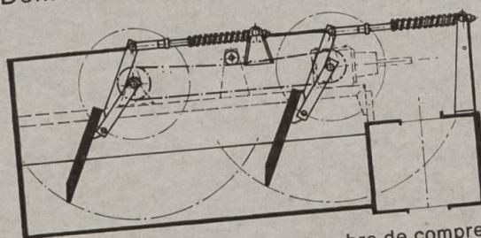
Alimentation constante de la chambre de compression par le système AMA. Deux fourches en ligne à mouvement synchrone introduisent dans la chambre de compression la quantité automatiquement dosée de fourrage.
