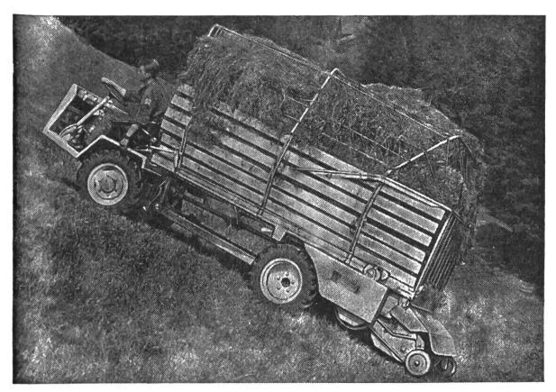
L'autochargeuse automotrice ALPINISTE est un véhicule universel qui se rit des pentes les plus raides et accidentées dans l'agriculture alpine. Grâce à son excellente stabilité en pente, l'ALPINISTE se fait un jeu des côtes même supérieures à 60 %. Il a une capacité utile de 12 m³.
