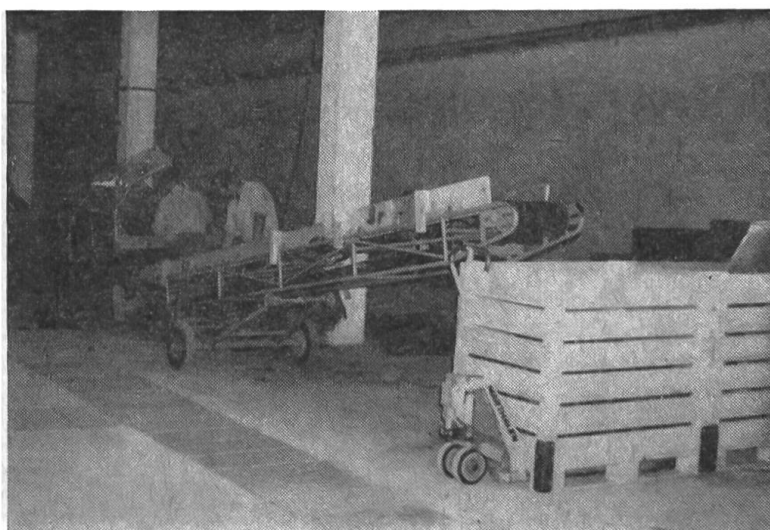
Fig. 12: Lors de l'application de la méthode de travail B 2, les pommes de terre sont soumises à un pré-triage avant leur déversement dans les paloxes par un ruban transporteur. Ainsi les petits tubercules, la terre et les corps étrangers ne chargent pas inutilement les caisses-palettes.
