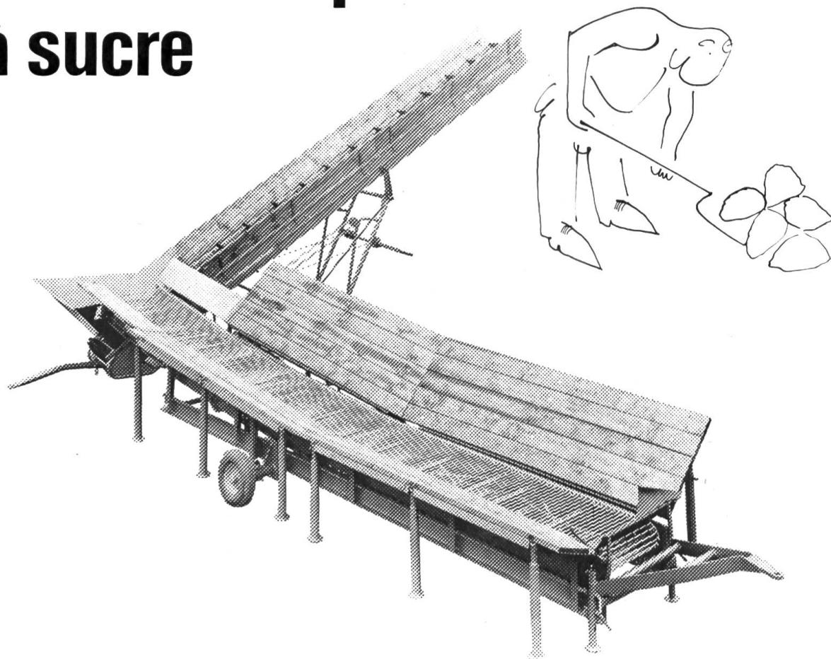
Rationnel et hors-ligne. Rationnel pour le transbordement de matières lourdes et plus spécialement de betteraves à sucre. Hors-ligne par sa grande résistance, son excellente construction et ses possibilités d'allongement (éléments préfabriqués).
