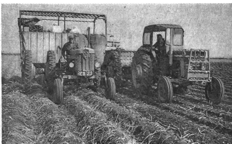
Fig. 1: Le nouveau système de jumelage pour les roues arrière des tracteurs imaginé et réalisé par la fabrique anglaise «Avon». Les roues appairées sont fixées l'une à l'autre avec un certain écartement par une douille d'espacement. Elles peuvent ainsi rouler chacune dans un sillon (solution particulièrement intéressante avec une récolteuse de pommes de terre).
