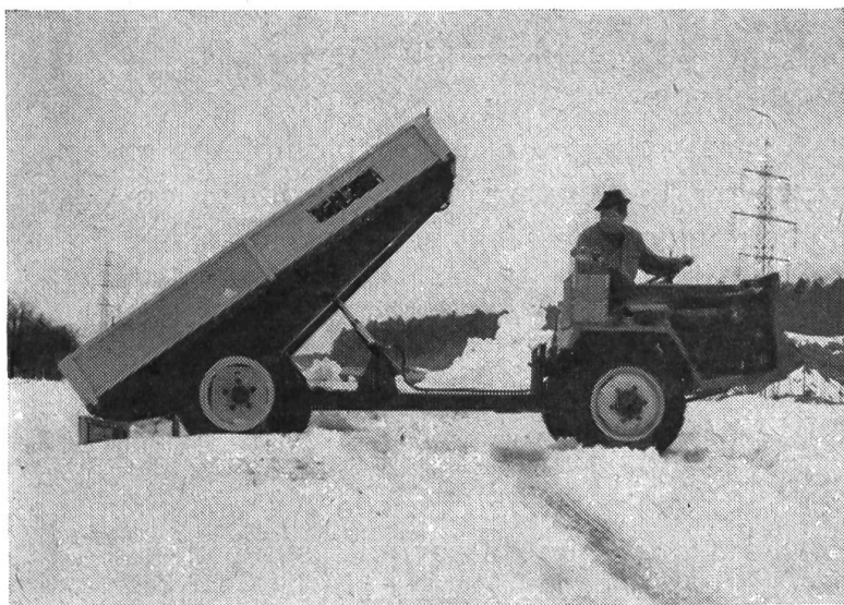
Fig. 7: Aspect d'un char automoteur équipé d'une caisse pouvant être basculée hydrauliquement vers l'arrière par l'intermédiaire d'un seul vérin articulé sur le châssis. Pour assurer le glissement des produits lors du déchargement, il faut que l'angle de basculement soit de 60° au minimum. La pression d'huile nécessaire est empruntée à un bloc hydraulique (monté sur le char automoteur) par l'intermédiaire d'une prise de pression et d'une canalisation souple. Le retour de la caisse à l'horizontale se fait par gravité ou par vérin à double effet. Ce dispositif de basculement hydraulique a fait brillamment ses preuves dans la pratique.
