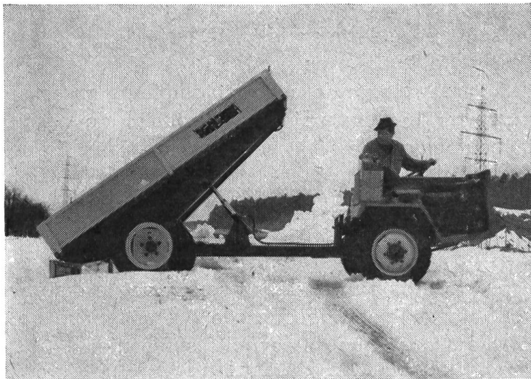
Fig. 7: Aspect d'un char automoteur équipé d'une caisse pouvant être basculée hydrauliquement vers l'arrière par l'intermédiaire d'un seul vérin articulé sur le châssis. Pour assurer le glissement des produits lors du déchargement, il faut que l'angle de basculement soit de 60° au minimum. La pression d'huile nécessaire est empruntée à un bloc hydraulique (monté sur le char automoteur) par l'intermédiaire d'une prise de pression et d'une canalisation souple. Le retour de la caisse à l'horizontale se fait par gravité ou par vérin à double effet. Ce dispositif de basculage hydraulique a fait brillamment ses preuves dans la pratique.
