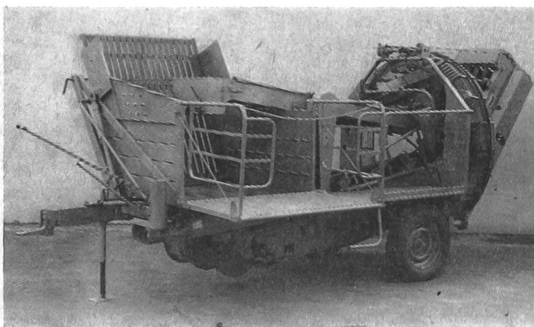
Fig. 13: La récolteuse de pommes de terre «Wisent» (arracheuse-ramasseuse effectuant une récolte totale) est dotée d'une trémie collectrice que l'on peut transformer à volonté en poste d'ensachage. En abaissant une de ses parois à l'horizontale (opération facile), on obtient une plate-forme spacieuse. Il suffit alors de monter un ensacheur au bout de la table de triage.
