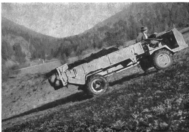
Fig. 4: Char automoteur équipé en épanduse de fumier à hérisson de type horizontal. — Pour travailler sur les herbages, il est indispensable qu'une telle machine soit capable de déchiqueter finement cet engrais naturel et de le répartir régulièrement sur le sol.
