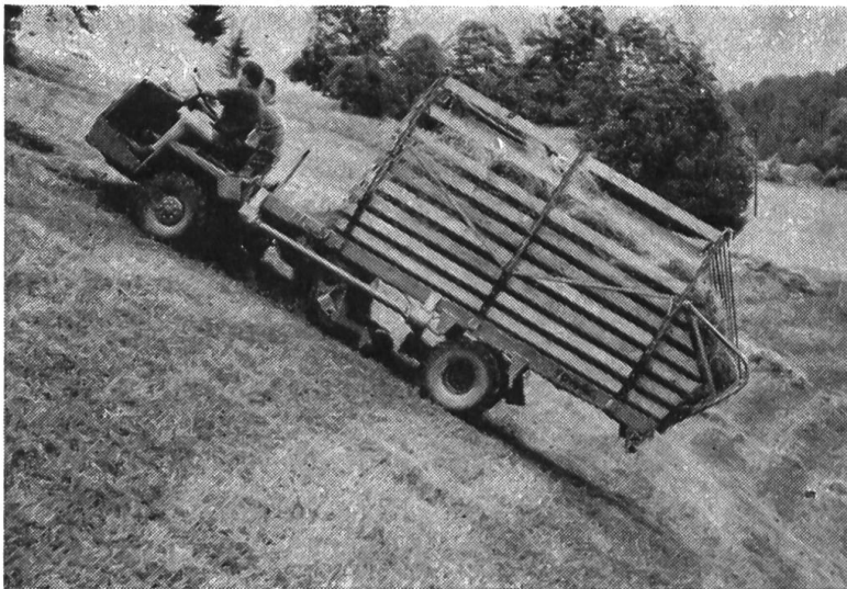
Fig. 6: Cette autochargeuse automotrice convient pour la reprise au sol de tous les fourrages préalablement disposés en andains. Malgré les roues de faible diamètre dont on l'a équipée, la machine en question est une très bonne grimpeuse.
