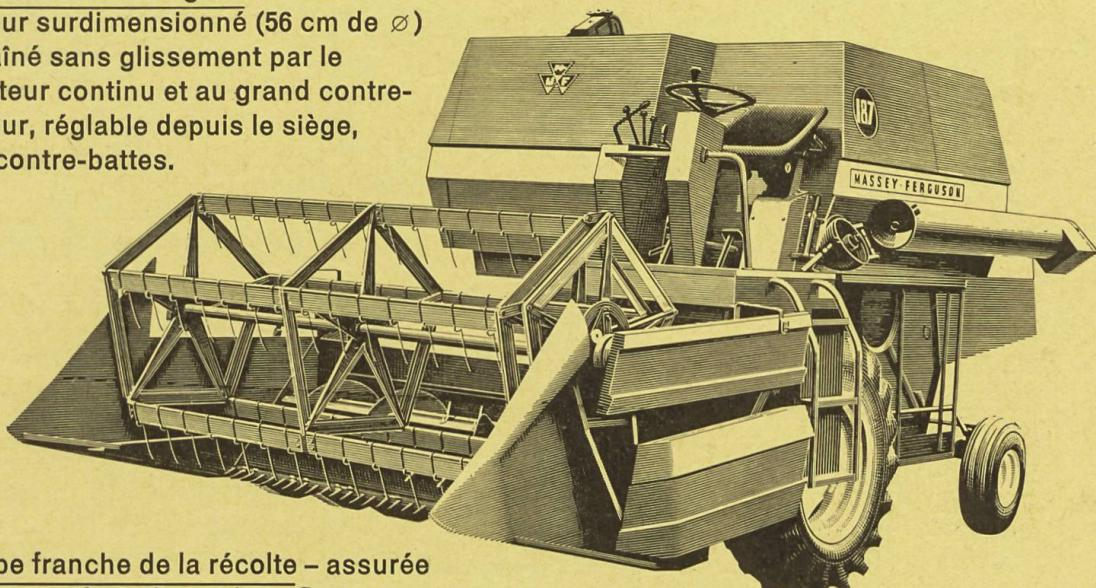
Coupe franche de la récolte – assurée par un système de guidage flottant du mécanisme de coupe.
