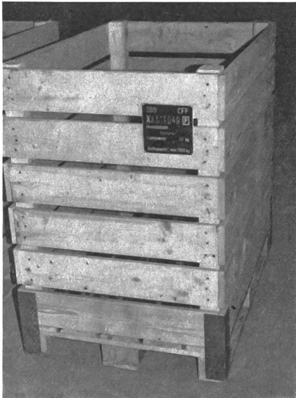
Fig. 1: Aspect de la paloxe (caisse-palette) conçue par la Commission suisse de la pomme de terre en collaboration avec les Chemins de fer fédéraux. Cette paloxe est constituée par une caisse surdimensionnée à claire-voie fixée par des boulons à une palette de type standard. Elle mesure 1 m 20 de long, 1 m 15 de haut et 80 cm de large. Sa contenance est de 0,85 m 3 et son poids à vide d'environ 73 kg. On distingue ici la plaquette d'immatriculation des CFF. Rappelons que la palette, qui sert de fond à la paloxe, comporte des lattes espacées montées sur des madriers. Elle est du type à quatre entrées. La fourche de l'élévateur de palettes (élévateur hydraulique porté) peut être ainsi engagée de n'importe quel côté sous le plancher de la caisse.
