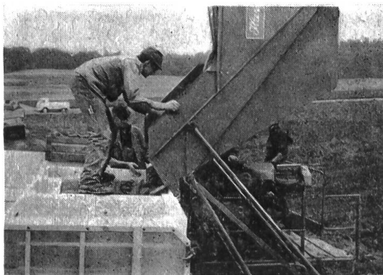
Fig 2 et 3: L'emploi d'une récolteuse de pommes de terre à ruban chargeur transversal (arracheuse-ramasseuse à élévateur) donne la possibilité de remplir directement les paloxes disposées sur un char roulant en parallèle mais nécessite par contre la mise en service de deux tracteurs (fig. 2). Si l'on utilise une récolteuse de pommes de terre à réservoir collecteur (arracheuse-ramasseuse à trémie), le vidage de ce récipient dans les paloxes se fait à l'extrémité du champ et n'exige qu'un seul tracteur (fig. 3).
