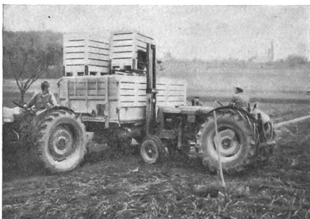
Fig. 4: Lors de l'emploi d'une arracheuse-aligneuse pour la récolte des pommes de terre, les paloxes amenées à pied d'œuvre et remplies à la main sont reprises au sol par un élévateur hydraulique porté à fourche et chargées sur une remorque. L'élévateur que l'on voit ici a été monté à l'avant du tracteur. Il en existe aussi qui se fixent à l'arrière. Plus pratiques, parce qu'ils facilitent les manœuvres, ces derniers demandent en revanche une plus grande routine du conducteur, qui doit assurer simultanément la commande du tracteur et de l'élévateur.
