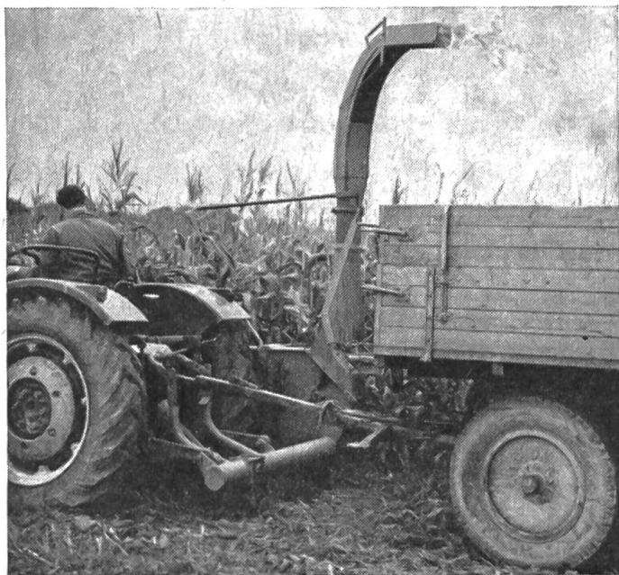
Fig. 1: Ramasseuse-hacheuse-chargeuse à fourrages semi-portée attelée en déport, ce qui permet d'accoupler le véhicule de récolte (ici un char ordinaire à pneus pourvu de ridelles et de hausses) dans l'axe de la machine de traction. Cette ramasseuse est du type à tambour hacheur disposé transversalement par rapport au sens de marche et pourvu de couteaux hélicoïdaux incurvés qui régularisent l'effort demandé tout en faisant fonction de pales de ventilation. Avec le maïs-fourrage, la ramasseuse-hacheuse-chargeuse fournit un travail impeccable concernant aussi bien la qualité du ramassage que la finesse du hachage et l'homogénéité de la masse du produit.
