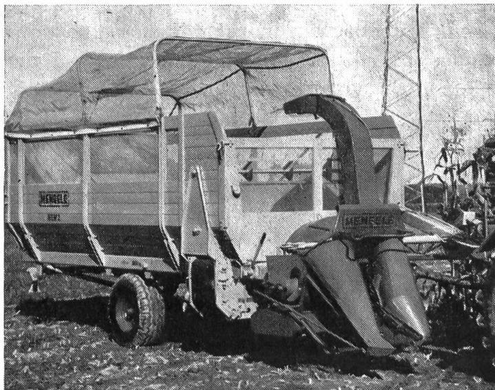
Fig. 3: Remorque autochargeuse-autodéchargeuse de type spécial équipée à l'avant d'une récolteuse de fourrages à tambour hacheur transversal où l'organe ramasseur (pick-up) a été remplacé par un équipement monorang à maïs-fourrage comportant une barre de coupe très courte (couteau constitué par une section de lame faucheuse). La récolteuse s'attelle en déport et la remorque autochargeuse-autodéchargeuse dans l'axe du tracteur. Cette dernière est également munie à l'avant d'un ruban déchargeur qui déverse le fourrage à volonté sur le côté droit ou sur le côté gauche.
