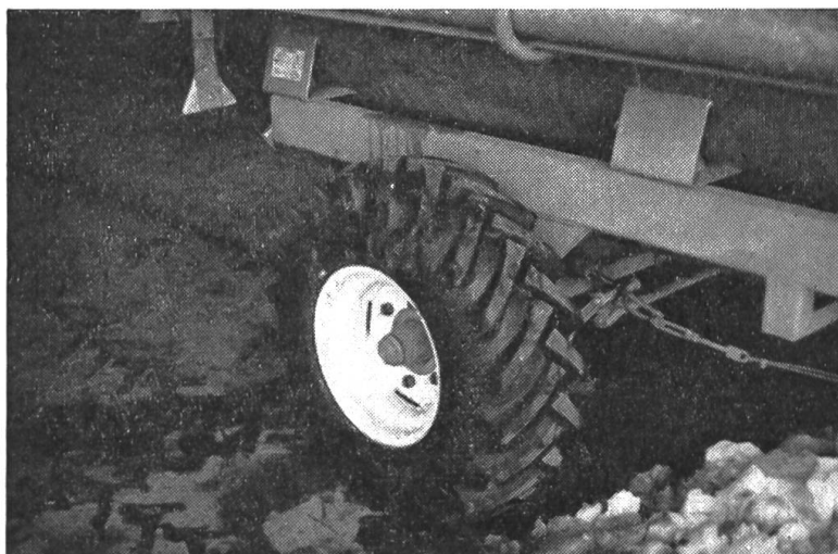
Fig. 5: Les pneus à profil «tracteurs AR» sont également indiqués pour les véhicules et machines agricoles lorsqu'on doit mettre ceux-ci en service sur des terrains déclinés et qu'il faut alors pouvoir les freiner de manière efficace.
