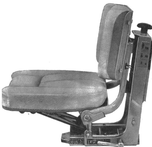
Les sièges sanitaires IFC pour conducteurs de tracteurs sont anatomiques et fonctionnels. On les a équipés entre autres d'une suspension à parallélogramme articulé et amortisseurs d'oscillations. Ils peuvent être rangés parmi les meilleures réalisations de ce genre existant à l'heure actuelle.
