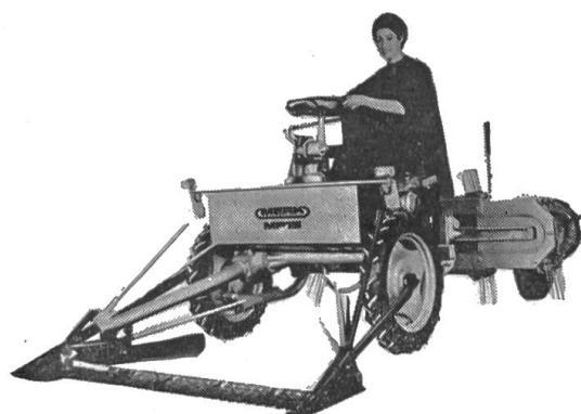
Le modèle P-33 constitue une réalisation foncièrement nouvelle. Il a été pourvu d'un moteur Diesel MWM de 34 ch SAE (31 ch DIN) et de la même boîte de vitesses que ci-dessus à 8 marches avant et 4 marches arrière. Ses prises de force, avec leurs multiples possibilités d'utilisation, représentent l'une des caractéristiques distinctives de cette machine. Il existe une prise de force à l'arrière (en aval de la transmission) et une prise de force à l'avant.
