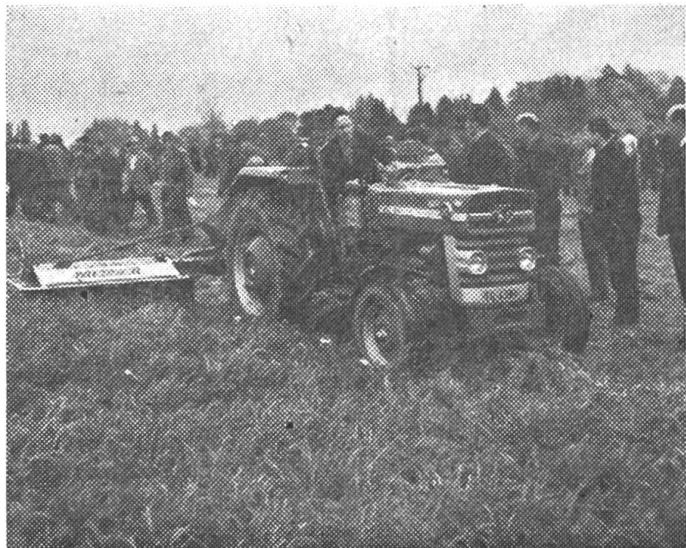
Tracteur équipé d'une faucheuse portée à tambours rotatifs à couteaux. Suivant le nombre de tambours et leur sens de rotation, cette machine confectionne deux petits andains ou un seul andain central. La superficie récoltée à l'heure avec elle, à une allure variant de 7 à 15 km/h, est importante. De nombreux agriculteurs l'ont observée au travail avec la plus grande attention.
