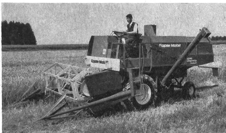
Aspect de la nouvelle moissonneuse-batteuse autotractée Epple-Buxbaum du modèle EM 840. Son rendement horaire en grain est de 4 tonnes. Entre autres équipements, elle comporte un moteur Perkins de 55 ch DIN à gasoil et un batteur de 80 cm de long et 50 cm de \varnothing à usages multiples avec contre-batteur combiné.
