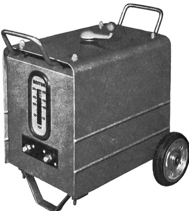
d'une grande capacité de travail. Afin d'obtenir des soudures de haute résistance susceptibles de supporter les sollicitations les plus fortes, on doit souvent utiliser, également dans l'agriculture, des électrodes spéciales ou bien en fonte. A ce moment-là, il faut que l'appareillage ait une tension à vide suffisamment élevée, c'est-à-dire d'au moins 65 à 70 volts.
