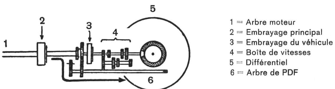
**Prise de force indépendante** (indépendante de la boîte de vitesses et indépendante de l'embrayage du véhicule). On l'appelle aussi prise de force «moteur». Elle convient principalement pour l'épanduse de fumier, la récolteuse de fourrages, la ramasseuse-presse, la moissonneuse-lieuse, la moissonneuse-batteuse, des installations fixes, etc.
