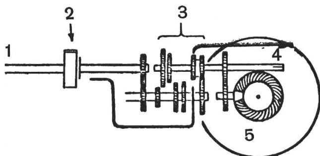
**Prise de force dépendante** (dépendante de la boîte de vitesses et dépendante de l'embrayage du véhicule). On l'appelle également prise de force «tracteur». Elle convient plus particulièrement pour la semi-remorque à essieu moteur, mais aussi pour le distributeur d'engrais, le semoir, le pulvérisateur, etc.
