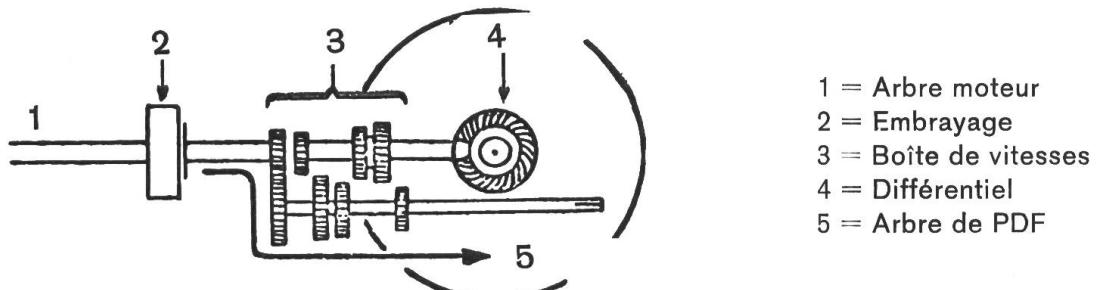
**Prise de force indépendante** (indépendante de la boîte de vitesses et indépendante de l'embrayage du véhicule). Peu répandue actuellement, elle convient pour la plupart des machines à prise de force.
