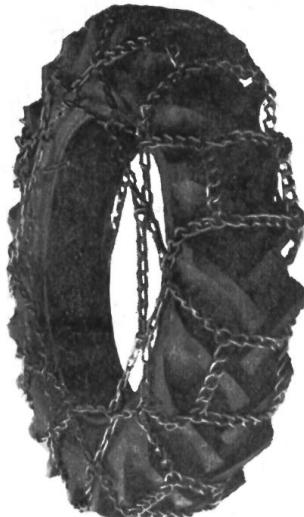
core être livrée à l'heure actuelle. Elle comporte des éléments d'un nouveau genre qui sont fixés de telle façon que seule une faible partie des maillons de chaîne disparaissent entre les barrettes de traction
