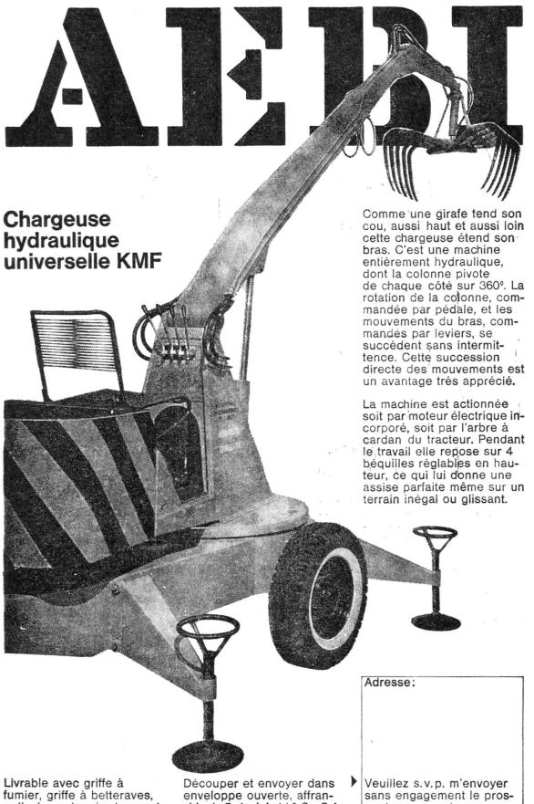
Livrable avec griffe à fumier, griffe à betteraves, pelle à gravier, équipement de drainage avec godet rétro.
