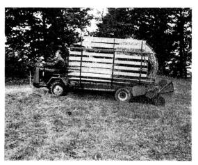
Fig. 5b et 5 c: .... soit encore sur un char automoteur à usages multiples (utilisé à gauche comme épandeuse de fumier et à droite comme autochargeuse).
