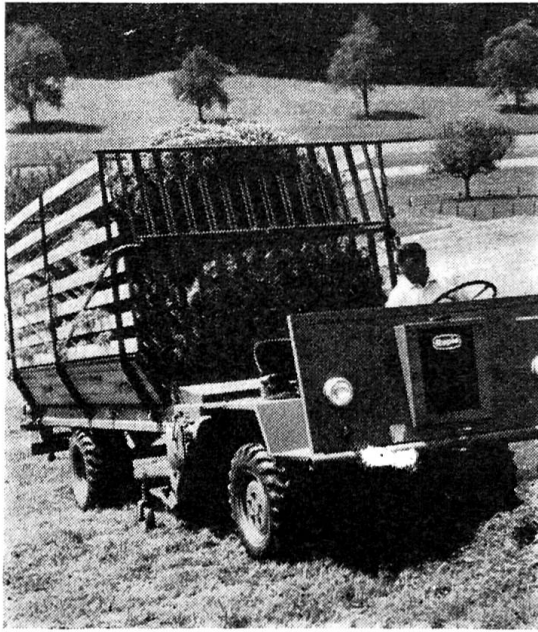
Fig. 5a: Les conditions particulières de l'exploitation en cause s'avèrent déterminantes lorsqu'il s'agit de porter son choix soit sur un char automoteur équipé en autochargeuse, soit sur un tracteur attelé à une remorque autochargeuse à plateau surbaissé ....
