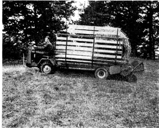
Fig. 5b et 5 c: .... soit encore sur un char automoteur à usages multiples (utilisé à gauche comme épandeur de fumier et à droite comme autochargeuse).
