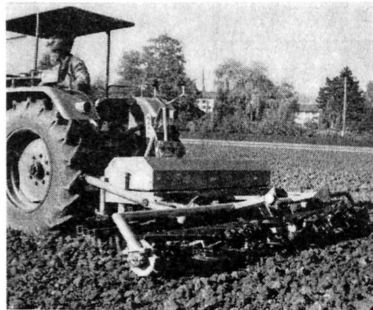
Fig. 27 et 28: Les motohersees à va-et-vient sont généralement constituées par deux ou trois barres porte-dents disposées perpendiculairement à l'axe de symétrie du tracteur. Elles sont animées de mouvements alternatifs rectilignes dans le sens horizontal. On leur adjoint fréquemment une niveleuse (fig. 27) ou une émotteuse à rouleau à fils de fer (fig. 28) pour réaliser l'émiettement des rangées de mottes se formant sur les côtés de la herse ainsi que l'égaiisation de la surface du champ.
