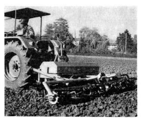
Fig. 27 et 28: Les motoherses à va-et-vient sont généralement constituées par deux ou trois barres porte-dents disposées perpendiculairement à l'axe de symétrie du tracteur. Elles sont animées de mouvements alternatifs rectilignes dans le sens horizontal. On leur adjoint fréquemment une niveleuse (fig. 27) ou une émotteuse à rouleau à fils de fer (fig. 28) pour réaliser l'émiettement des rangées de mottes se formant sur les côtés de la herse ainsi que l'égalisation de la surface du champ.
