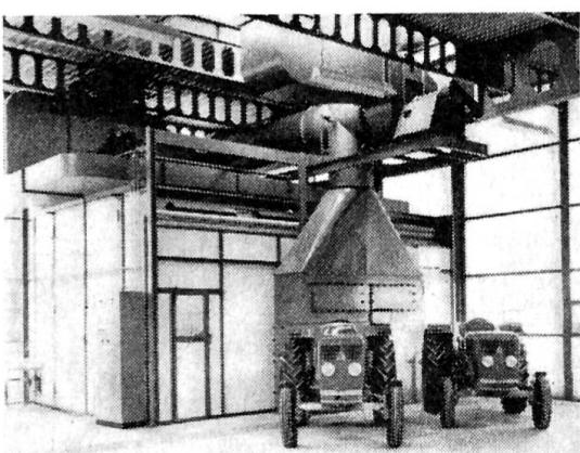
Une partie du vaste atelier a été réservée au service d'entretien, qui comporte des installations pour le lavage et le graissage des véhicules, ainsi que pour la peinture au pistolet. On distingue aussi une cabine où les carrosseries, après le capot sont façonnées de laque, sont soumises à un séchage-cuisson. Deux tracteurs agricoles de la nouvelle série 06 se trouvent devant cette cabine.
