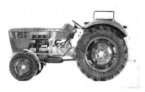
Aspect du tracteur agricole Deutz D 5006 dont le moteur développe 52 ch. Les différents organes logés sous le capot sont facilement accessibles et disposés de manière rationnelle.
