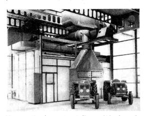
Une partie du vaste atelier a été réservée au service d'entretien, qui comporte des installations pour le lavage et le graissage des véhicules, ainsi que pour la peinture au pistolet. On distingue aussi une cabine où les carrosseries, après le capot sont facouches de laque, sont soumises à un séchage-cuisson. Deux tracteurs agricoles de la nouvelle série 06 se trouvent devant cette cabine.
