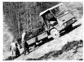
Ces illustrations montrent des chars automoteurs (véhicules tracteurs et porteurs tousterrains) utilisés sur des pentes fortement inclinées pour transporter des produits de deux sortes.
