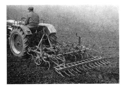
Fig. 19: Le cultivateur à dents vibrantes, aussi appelé herse danoise ou vibroculteur, est doté de dents flexibles aux caractéristiques suivantes: forme spéciale, plus grande longueur, plus grande élasticité, surface travaillante étroite et bombée. Ces dents sont fixées sur les trois ou quatre traverses du bâti à des intervalles variant de 10 à 12 cm.
